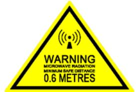
Pour une antenne **SAILOR 150 FleetBroadband**, la distance de sécurité minimale avec le panneau de l'antenne sur l'axe focal est de 0.6 m, sur la base d'un niveau de radiation émis de 10 W/m<sup>2</sup>. L'appareil génère un niveau de radiation de 100 W/m<sup>2</sup> à une distance de 0.2 m de l'avant du panneau de l'antenne. Veuillez consulter le schéma au-dessous.
